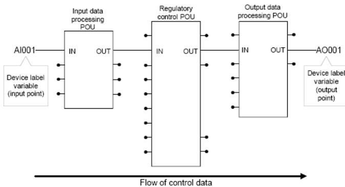
Conexão típica de NPAS\_POU
