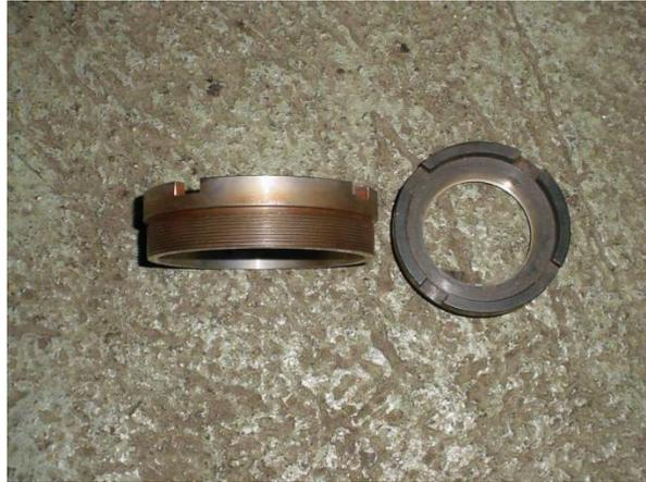
Figura 210. Anel sede da válvula globo
