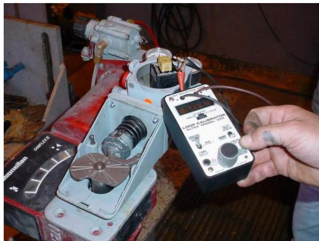
Figura 227. Exemplo de instalação de um posicionador eletropneumático
